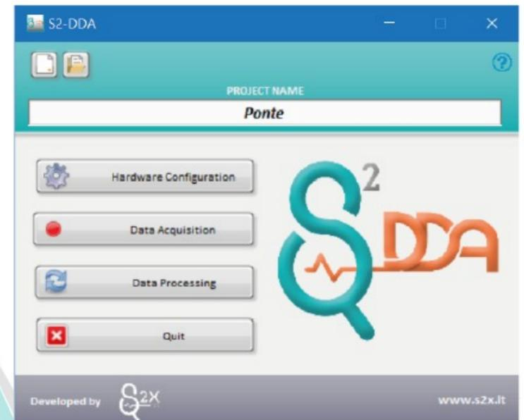
Il software è in grado di gestire anche sistemi di acquisizione multipli configurati in architetture distribuite sincronizzate di tipo master-slave tra i vari acquisitori.
